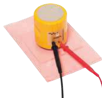
příklad použití: měření soustřednou sondou
