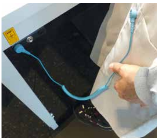
zemnění pomocí kablíku
