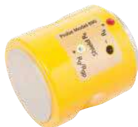
válcová sonda ø 63,5 mm
